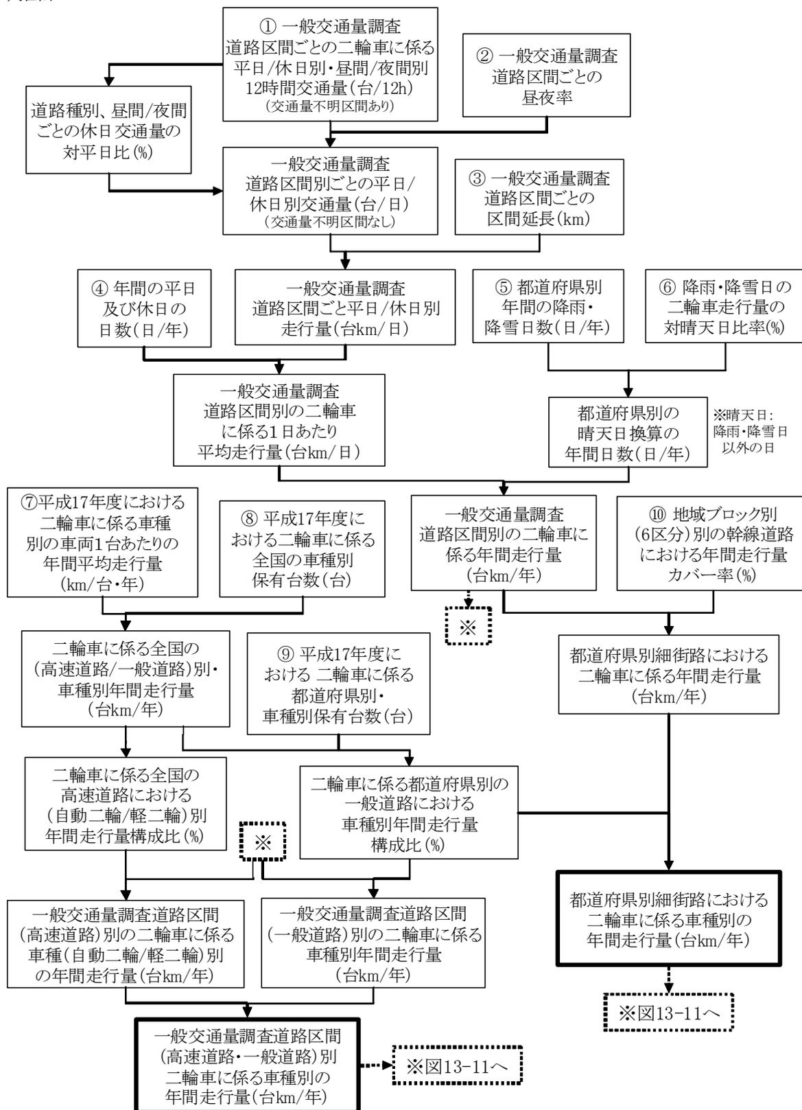
図 13-10 一般交通量調査道路区間別及び細街路年間走行量の推計フロー
