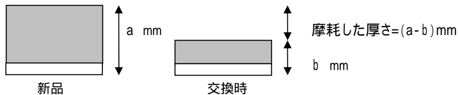
図 16-2 摩耗した厚さ(「制輪子、制輪子ライニング」の場合のイメージ)
