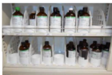
【実験室の試薬瓶の転倒・衝突対策】
