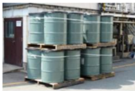
【ドラム缶平置き時の落下防止例】
