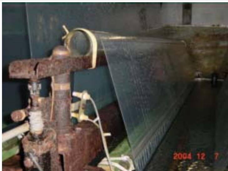
写真1 セロハン製造(抄造)工程
