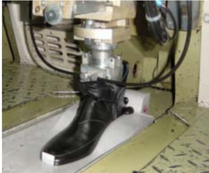
写真1 射出成型の様子
