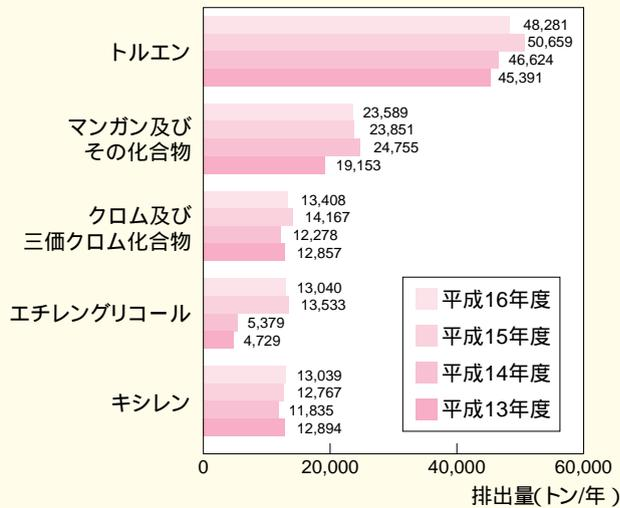
廃棄物としての届出移動量上位5物質の構成は平成15年度と同じです。2番目に多いマンガンは、合金の原料や鉄鋼製品を製造するときの添加剤などとして使用されています。また、マンガンの化合物としては、乾電池や酸化剤に使われる二酸化マンガンを飲料水の処理などに使われる過マンガン酸カリウムなどがあります。3番目のクロム及び三価クロム化合物は、合金の成分として特殊鋼や非鉄金属などに使用されています。
