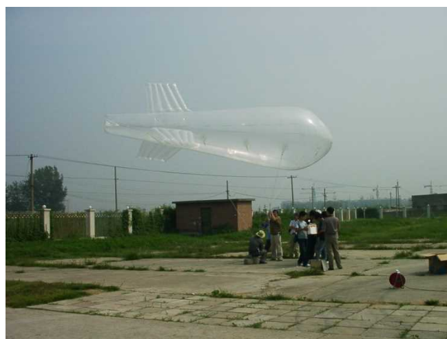
図 2-2 気球による上空のエアロゾ 観測
