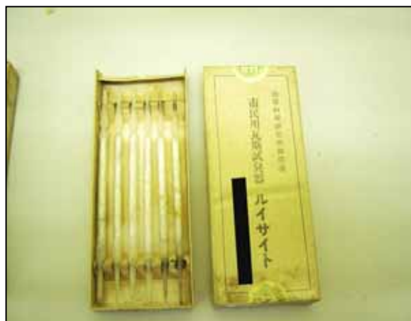
「市民用瓦斯試臭器 ルイサイト」の箱の外観と内部の様子
