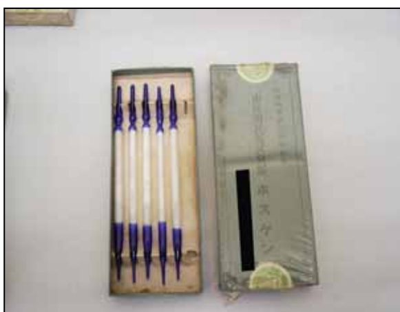
「市民用瓦斯試臭器 ホスゲン」の箱の外観と内部の様子
