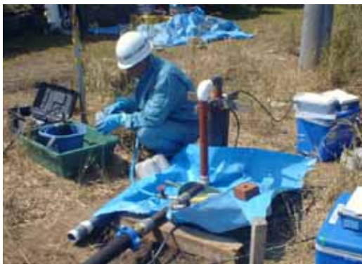
揚水調査の状況(揚水及び採水)
