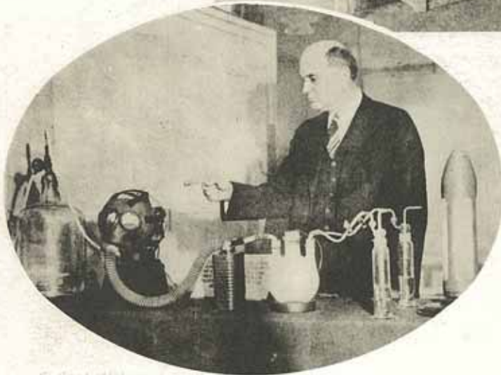
鹽化「アンモニウム」の煙を吸收罐に通じて其性能を試験する光景にして圖中中央の瓶内の白煙は吸收罐に吸收せられ左方の瓶内には透明なる空氣を残す點に注意せよ (H. T.)
