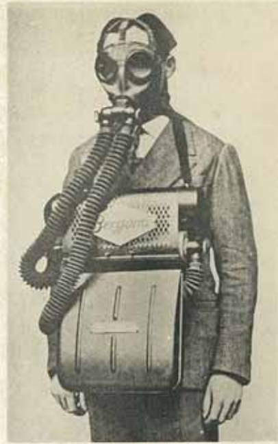
塩素酸「カリ」剤による酸素呼吸器(獨逸製)
