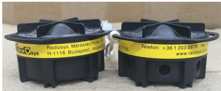
図 II-5 RADUET の外観。左が低換気率容器であり、右が高換気率容器である。
