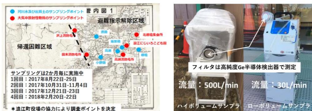
図 II-1 大気中放射性物質の採取地点と大気試料採取の様子。
