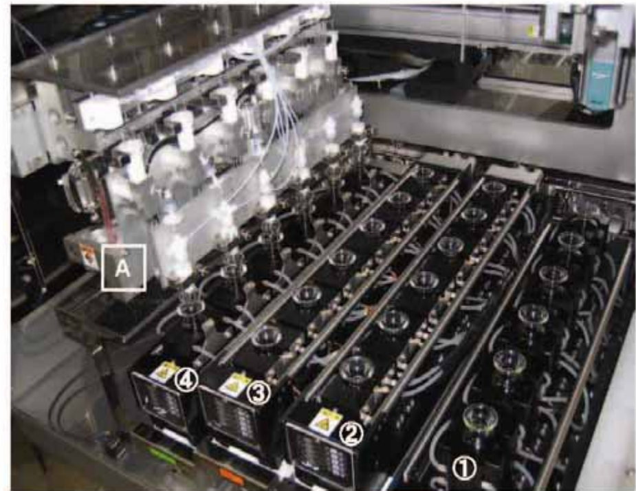
写真2 カラムクロマト精製装置内部
