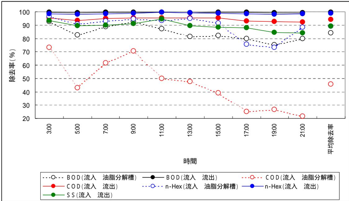
図4 - 10(1) 日間変動調査の除去率 12月10日(水)
