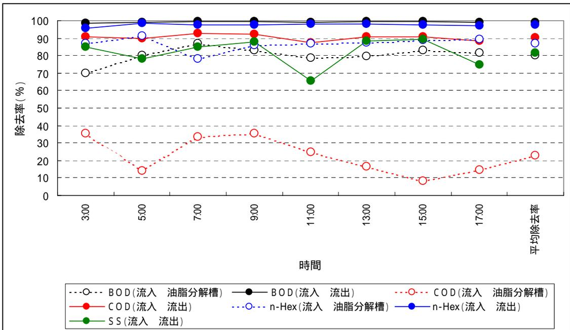
図4 - 10(2) 日間変動調査の除去率 12月13日(土)
