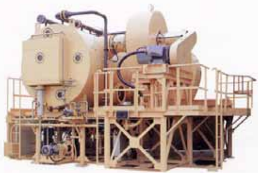
Ảnh: Thiết bị cô đặc VVCC hiệu suất cao có sử dụng bơm nhiệt phù hợp với xử lý cô đặc khối lượng lớn
