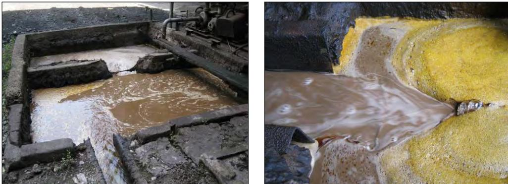
図 2.1.4 CPO 製造工場からの高含油廃水の一例
