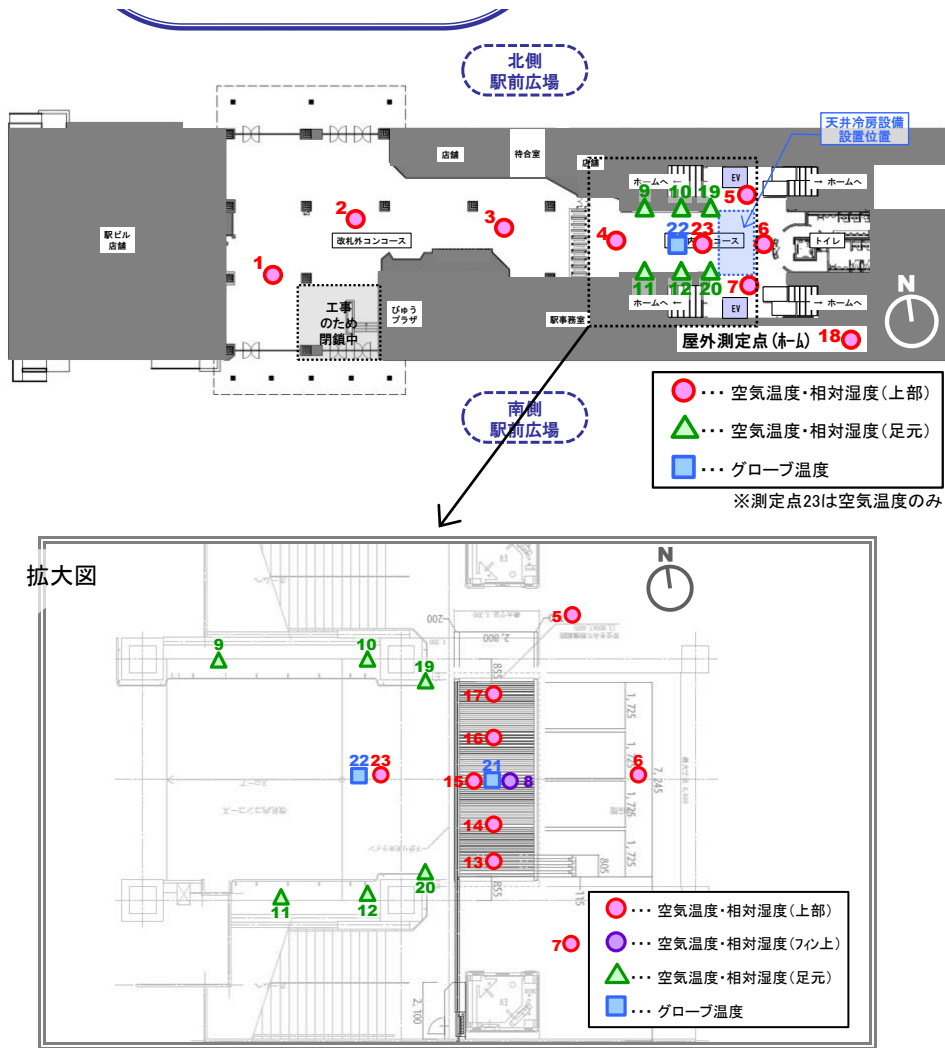
図 6.36 長期測定の測定器設置場所（下図は天井冷房システム周辺の拡大図）
