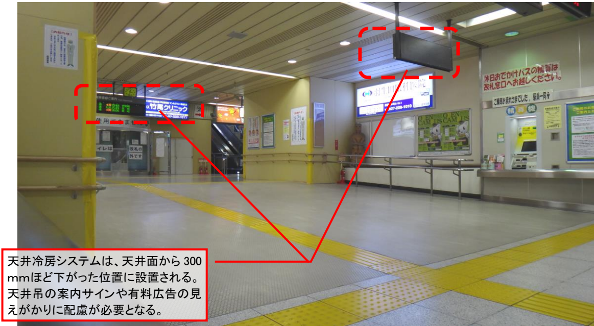
図 6.31 天井冷房システム設置上の留意点②
