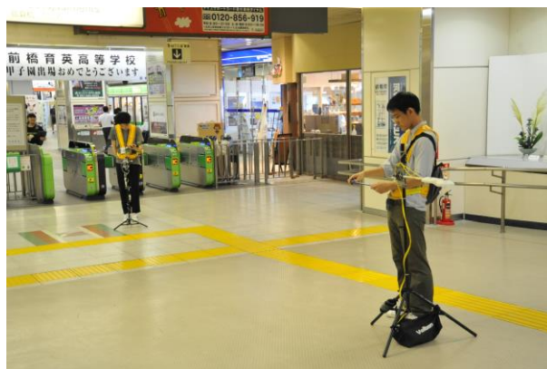
図 6.39 集中測定の実施状況（手前：放射環境測定，奥：居住域4要素測定）
