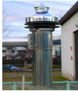
図 4.3 気温センサーを入れる通風筒の例（断面と概観） 109
