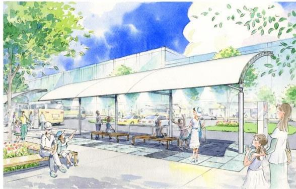
高反射性の日除けと微細ミスト、保水性ブロックによるバス停を表現した。
