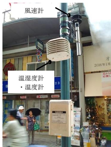
図 2.32 街灯への測器設置状況
