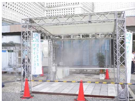
図 7.17 光触媒加工が施された遮熱性膜 4 （天井面の日除けとして検討）
