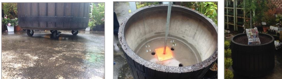
図 5.81 樹木ミスト (左：ストッパー付タイヤ、中：プランター内部、右：全体図)
