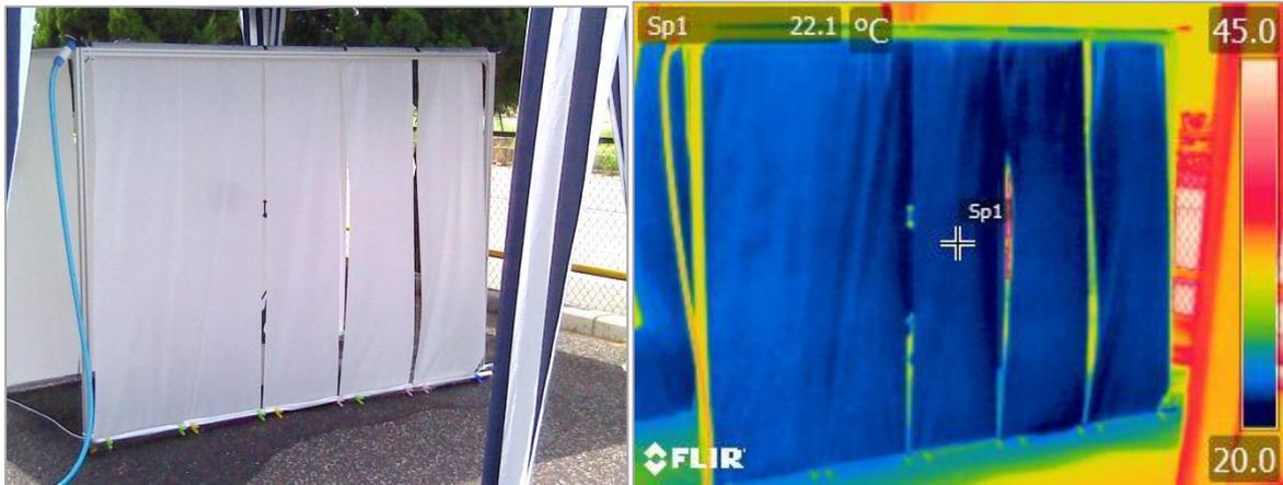
図 2.2 冷却不織布の表面温度
