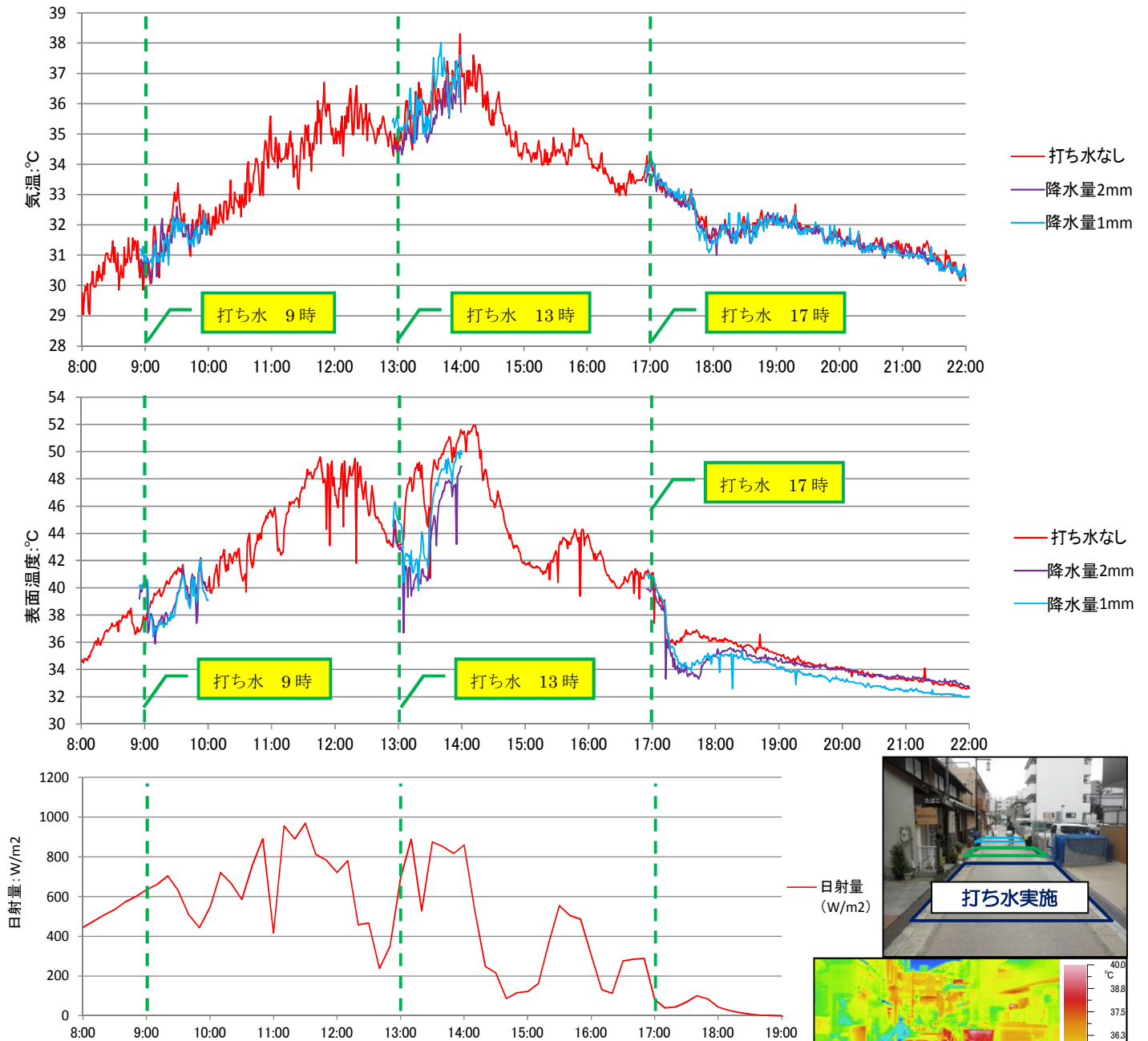
図 6.38 打ち水による気温の変化 (上)、打ち水による表面温度の変化 (中)、日射量 (下) (8/7)
