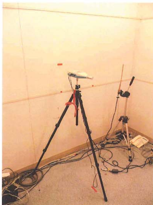
図 2.3.2.2 出力音の測定に使用した低周波音レベル計
