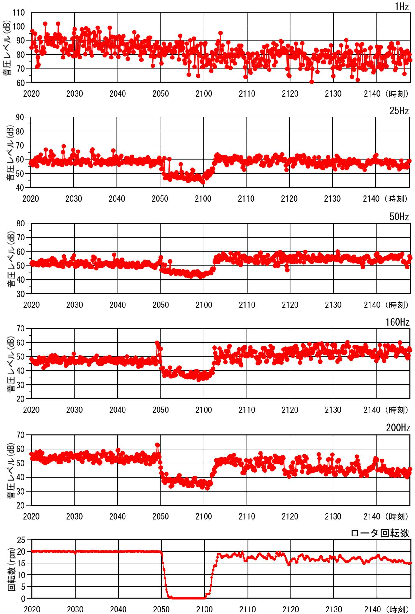
図2. 2. 1. 46 風車音の周波数別音圧レベル時間変動とロータ回転数の時間変化
