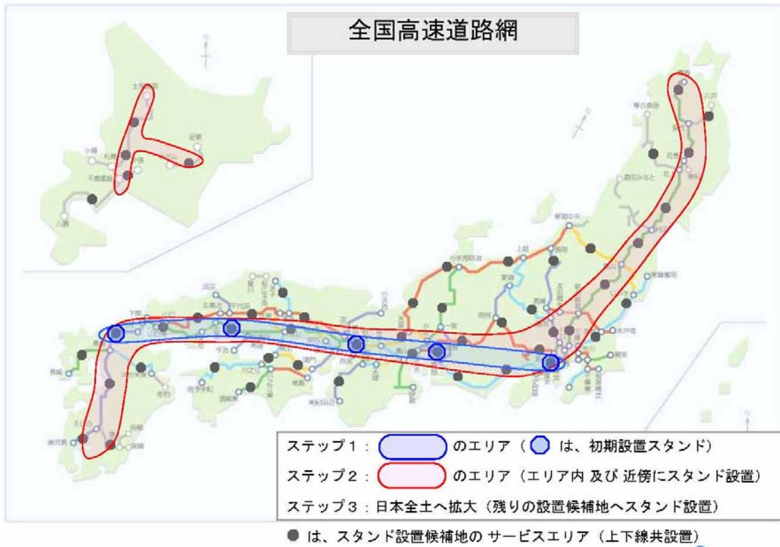
図 2.8.2 全国高速道路サービスエリアへの天然ガス充填スタンド整備例
