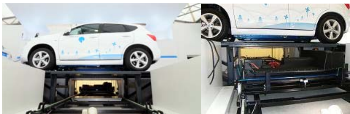
図 2.5.7 電池着脱式充電システムにおける電池交換シーン
