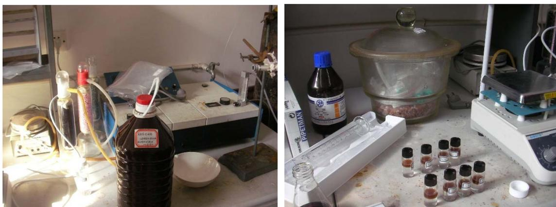
規模によって異なるが、酸触媒法では 80-90℃に加熱・反応し、中和後 KOH 触媒によってメチルエステルを生成する。反応後は蒸留ではなく、水洗い、乾燥後の BDF の品質を検査する必要がある。
