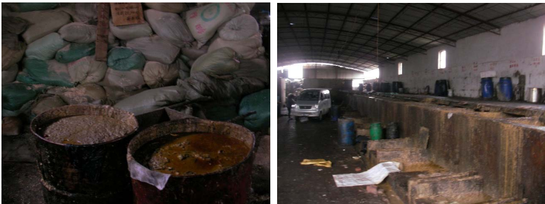
写真 3-1 「廃食用油の回収状況：（左）搬入された廃食用油（右）ろ過油池」
