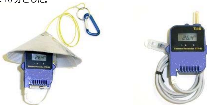
図3-1 測定機器の概観(左:屋外用温度計、右:室内用温湿度計)
