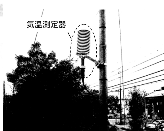
図 1 - 4 気温・風向・風速測定器の設置状況 (猿島町役場) 図 1 - 5 気温測定器の設置状況 (東松山)
