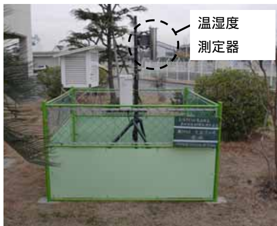
図1-6 温湿度測定器の設置状況（大庭浄水場）
