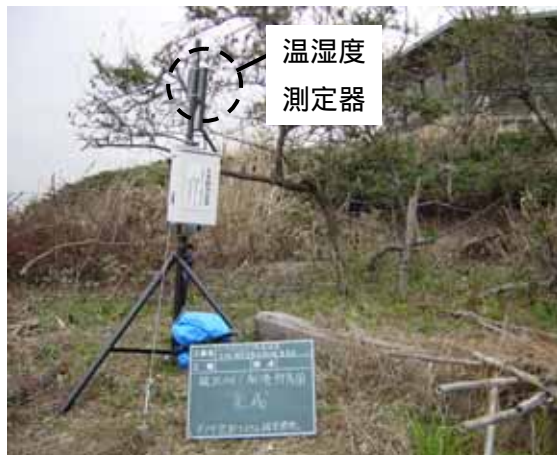
図1-7 温湿度測定器の設置状況（南港野鳥園）
