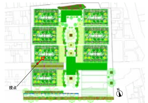
図4-43 植栽による表面温度低下効果(全面改善案 上層住宅エリア：午前12時)
