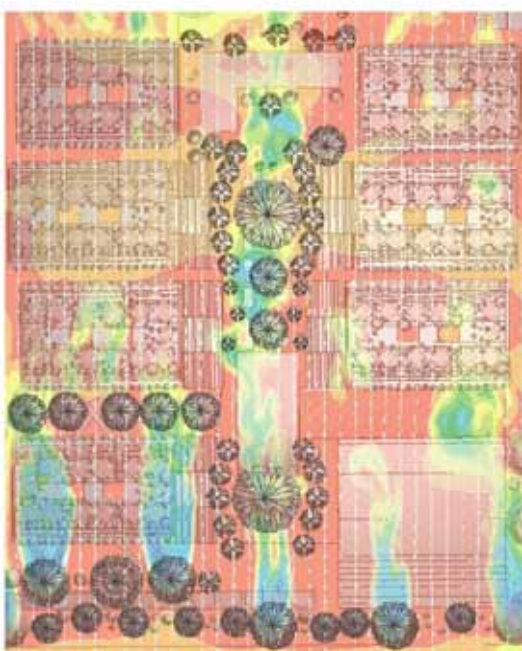
図 4 - 23(3) 風の流れの評価結果 (水平断面) (GL40m、50m)
