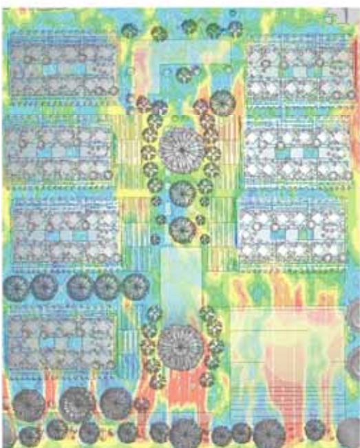
図 4 - 23(2) 風の流れの評価結果 (水平断面) (GL20m、30m)
