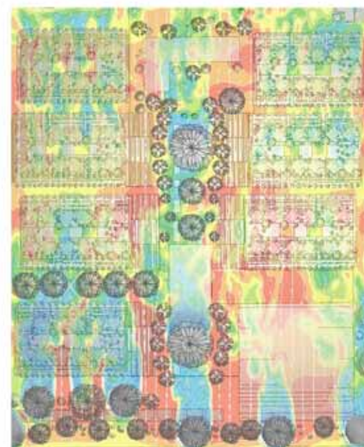
図 4 - 23(2) 風の流れの評価結果 (水平断面) (GL20m、30m)
