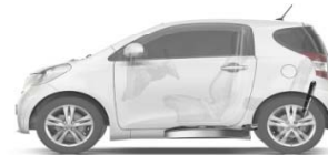
超薄型燃料タンクの床下配置
