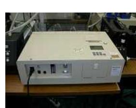
図 3.131 繊維状粒子自動計測器の例
