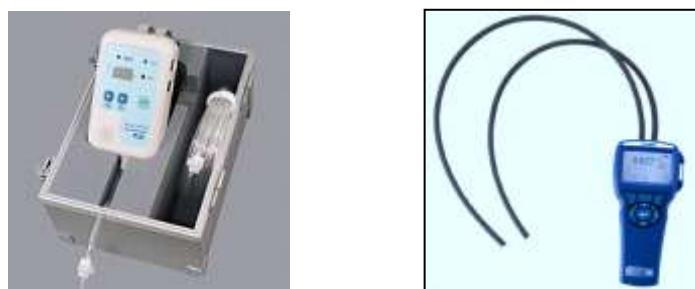
図3.5 マイクロマノメーター（精密微差圧計）例
