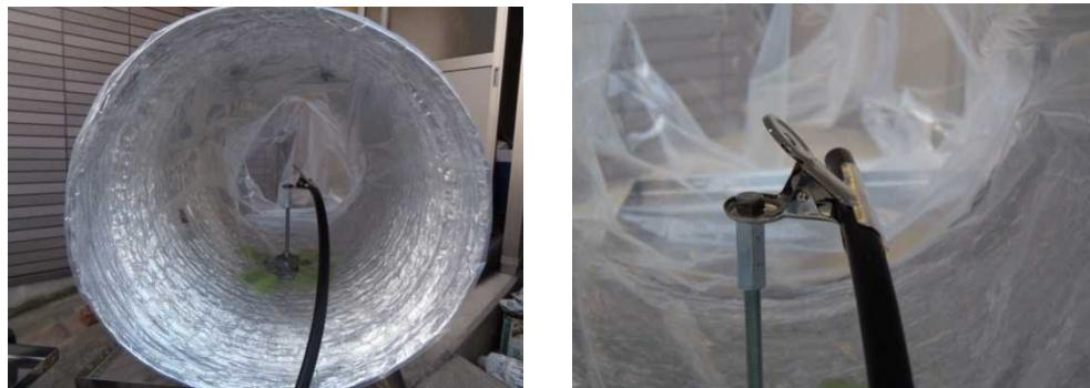
図 3. 124 チューブ配管を使用した場合の排気ダクトの測定例
