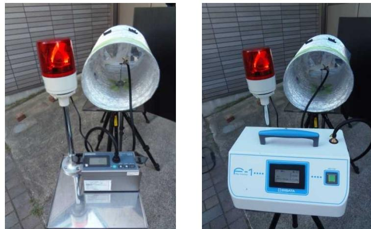
図 3. 126 排気ダクト内の測定時に警告灯を設置した例
