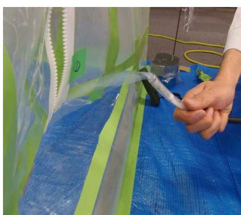
図3.121 スモークテスターによる確認
