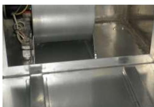
図 3.26 フレームと本体の接合部の隙間のコーティング場所
