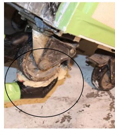
図 3.78 漏れの発生しやすい箇所の例
