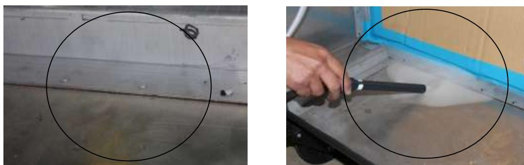
図 3.25 スモークテスターによる漏れの確認
