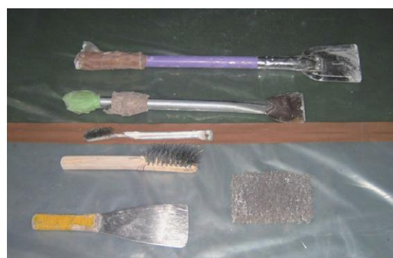
図3.55 除去作業用の手工具の例
