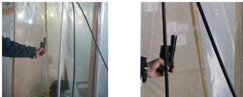
図3.120 セキュリティーゾーンの入口の気流方向の確認
