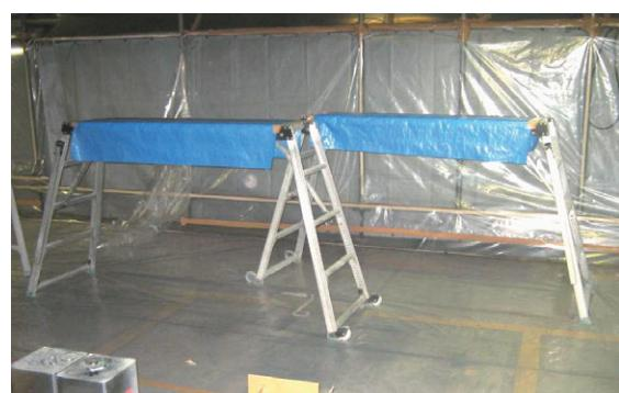
図3.54 可搬式作業台の例
