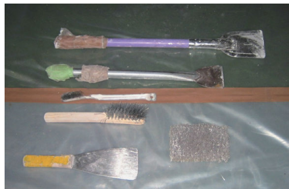
図 3.55 除去作業用の手工具の例
