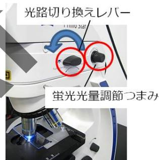
図 3 0 蛍光顕微鏡への切り換え
