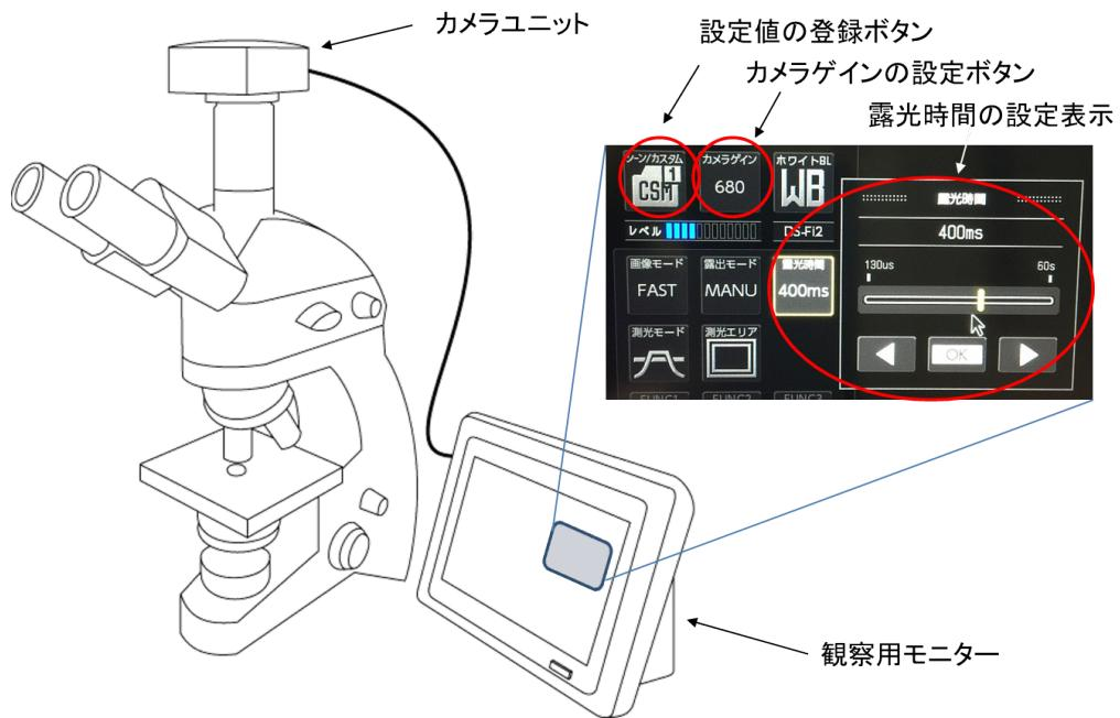
顕微鏡のカメラポートにカメラを取り付けて観察用モニターと接続することにより、観察視野の映像をモニター上に表示させ確認することができる（左）。カメラの感度をモニター上で設定することで、外部環境（明るさ）によらず一定の判定ができる。また、順応の問題を解決できる。
