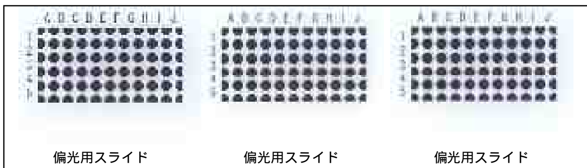
図-2 作成した位相差/偏光顕微鏡法の試験用スライド（実体顕微鏡写真）
