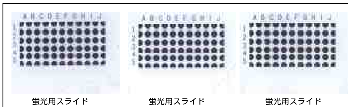
図-4 作成した位相差 / 蛍光顕微鏡法の試験用スライド (実体顕微鏡写真)
