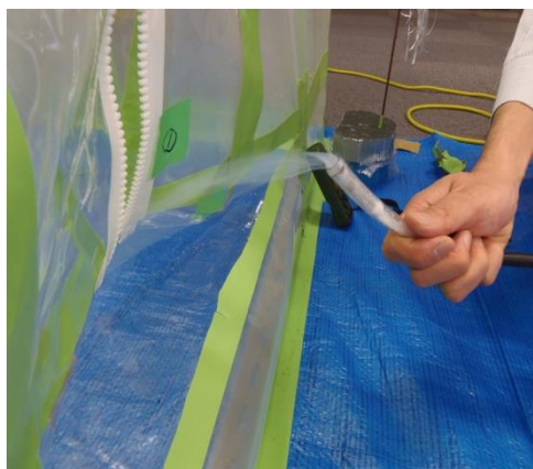
図 4.14.10 スモークテスターによる確認
