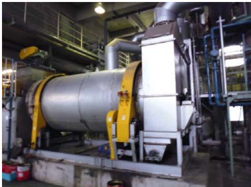
写真 1 汚泥乾燥炉（800℃で熱風乾燥）
