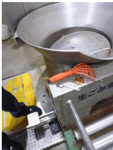
写真2 生ゴミの投入口
