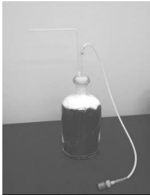
写真3 無臭水製造装置の例
