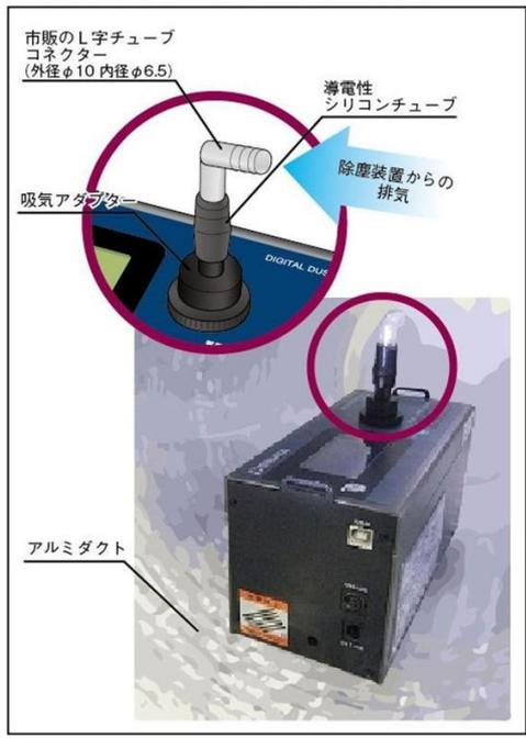
図 4.14.16 ダクト内の排気を直接測定する場合の測定例
