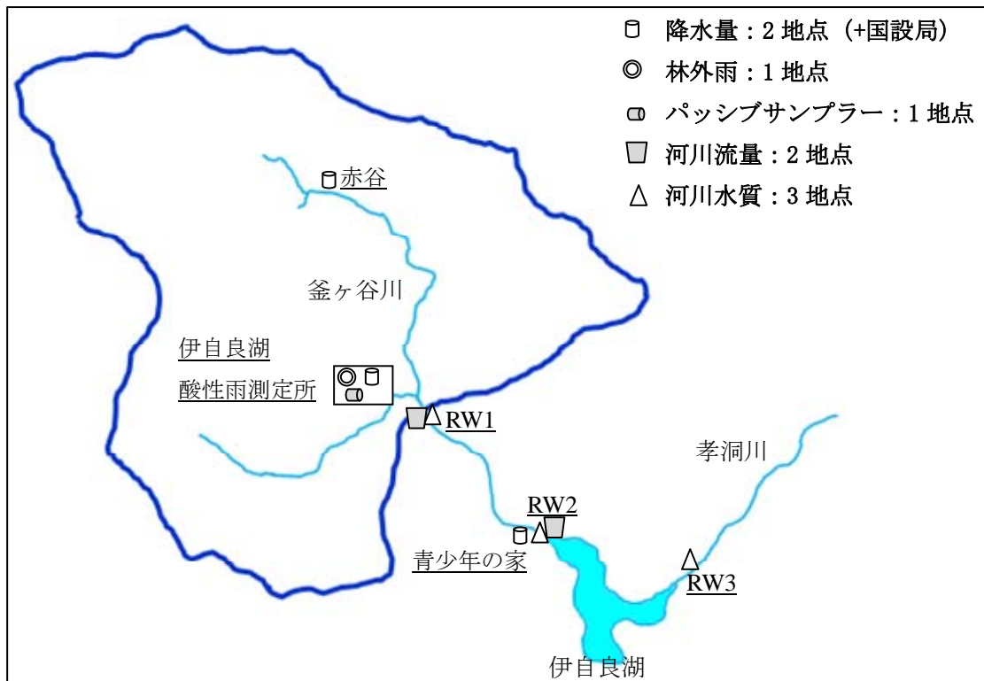
図 7-1. 伊自良湖集水域モニタリング装置配置図
