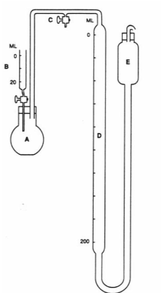
図 2.5. 炭酸塩を測定するための容量カルシメータ
