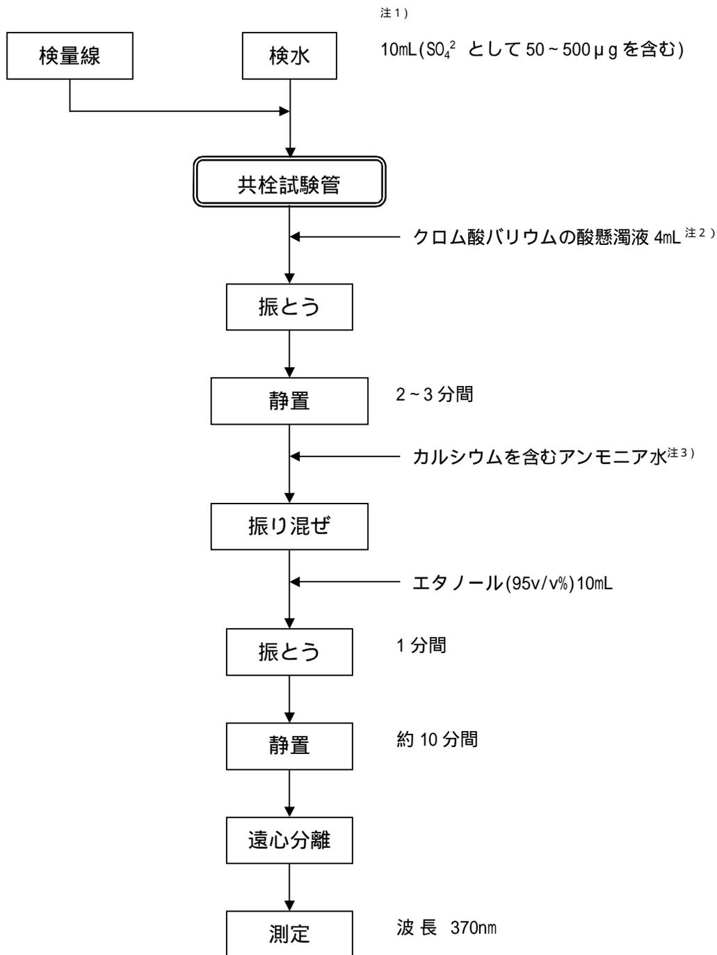
注1) この試験方法は酸濃度が影響するので、検水が酸性又はアルカリ性の場合には中和してから試験を行う。また、測定中の検水温度は20~30℃に保つようにする。
