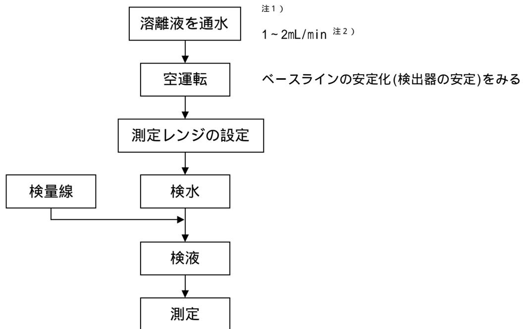
注1) 装置が除去カラム装着型の場合、除去液も同時に流す。
