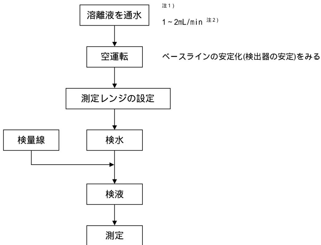
注1) 装置が除去カラム装着型の場合、除去液も同時に流す。
