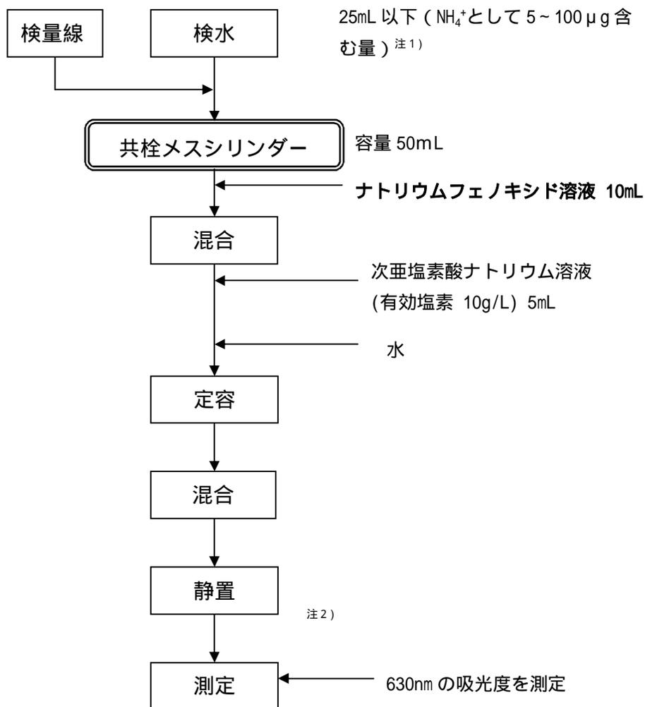
注1) 窒素として 100  $\mu\text{g}$  以上の場合には試験溶液の量を適宜減らし、水を加えて 25mL として用いる。
