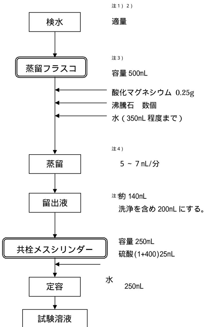
注1) インドフェノール法で蒸留を行う場合は、 $\text{NH}_4^+$ として  $40\mu\text{g}$  以上含むように採ること。
