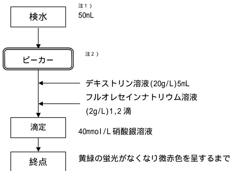
注1) 試料に著しい濁りが認められる場合は、グラスファイバーフィルターでろ過し、最初のろ液約 50mL を捨て、次のろ液を検液とする。
