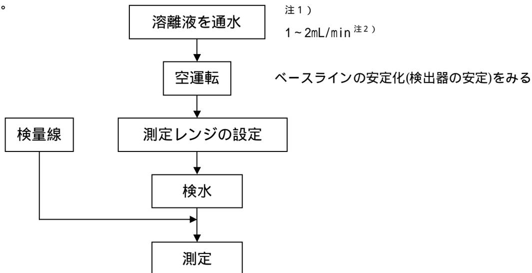
注1) 装置が除去カラム装着型の場合、除去液も同時に流す。
