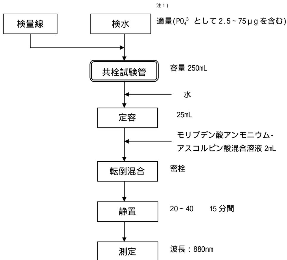
注1) 試料が中性付近でないときには、*p*-ニトロフェノール指示薬(1g/L)を加え、水酸化ナトリウム溶液(40g/L)又は硫酸(1+35)を用いて、わずかに黄色を呈するまで中和したものを検水とする。ただし、このときアルミニウムなどの水酸化物の沈殿が生じる場合には、沈殿が生じる直前で止める。この操作を行った場合、濃度計算のときに補正を要する。
