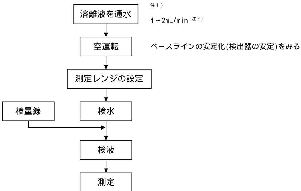
注1) 装置が徐去カラム装着型の場合、除去液も同時に流す。
