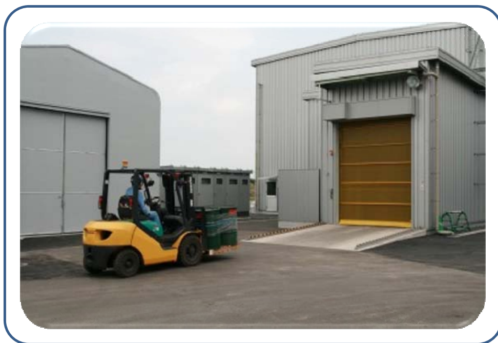
図 2.3-2 飛散防止措置が講じられた施設内移動の例（ドラム缶）
