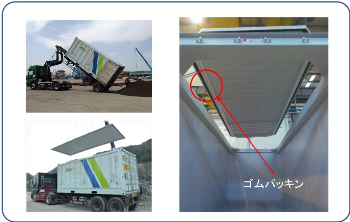
図 3.4.1-4 JIS 等密閉型コンテナの一例（ISO1496-1 の密閉型のコンテナ）
