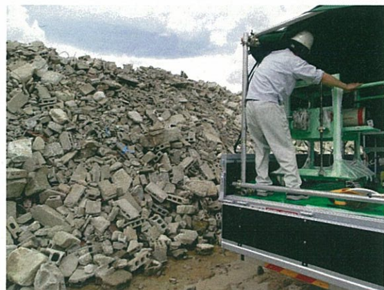
災害廃棄物(コンクリート対象物)のin-situ測定の様子(福島市松川工業団地の例)
