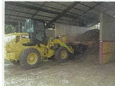
ホイールローダーによる攪拌減容化作業
