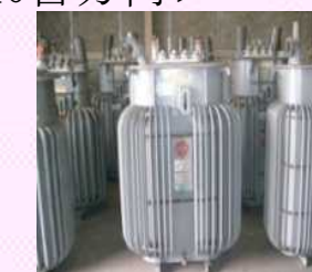
PCBが含まれる高圧トランス
