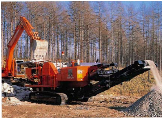
自走式破碎機による骨材再生作業
